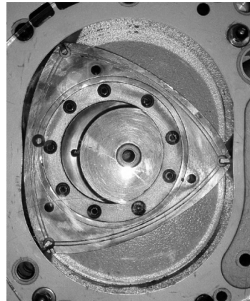
Abb. 2: Kreiskolbenmaschine (vgl. Farbbild 17)
